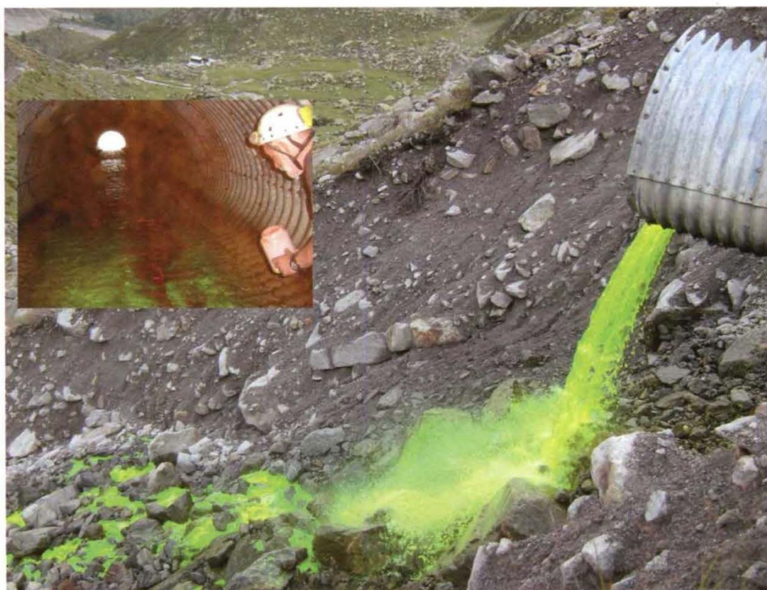
Lago delle Locce: rilascio della fluoresceina nell'emissario
