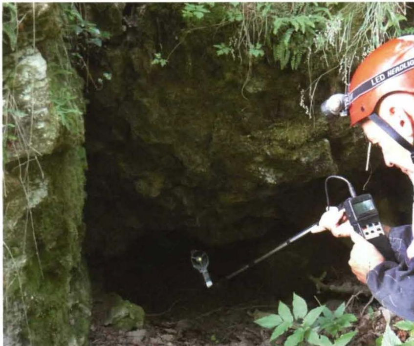
Misura anemometrica ad ingresso grotta
